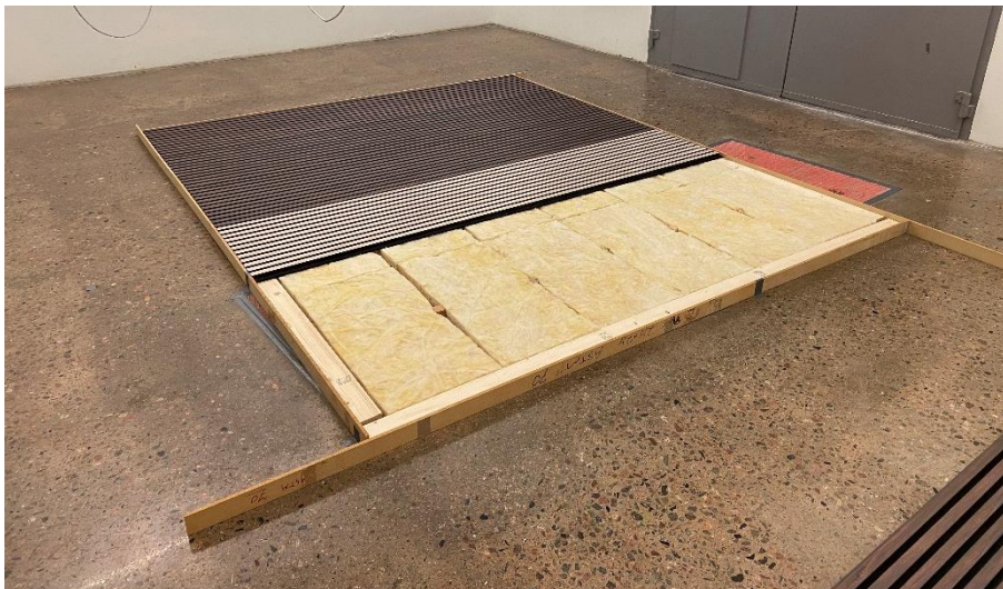
Bild 2 – Provobjektet monterat på 45 mm höga regler med isolering mellan.
