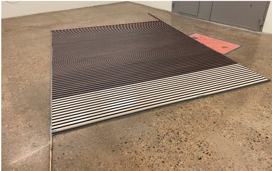
Bild 1 – Provobjektet monterat direkt på golv.
